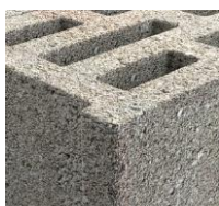
Легкий бетон (блоки с пустотами)
